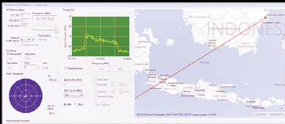
Gambar 4 : Deteksi arah pancaran salah satu pengguna frekuensi 14180 KHz dengan azimuth 240° arah Jakarta dengan mode transmisi SSB-USB power 100 watt.
