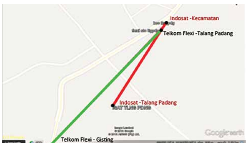
Gambar3 : Mapping gangguan interferensi microwave link Telkom Flexi oleh Indosat
