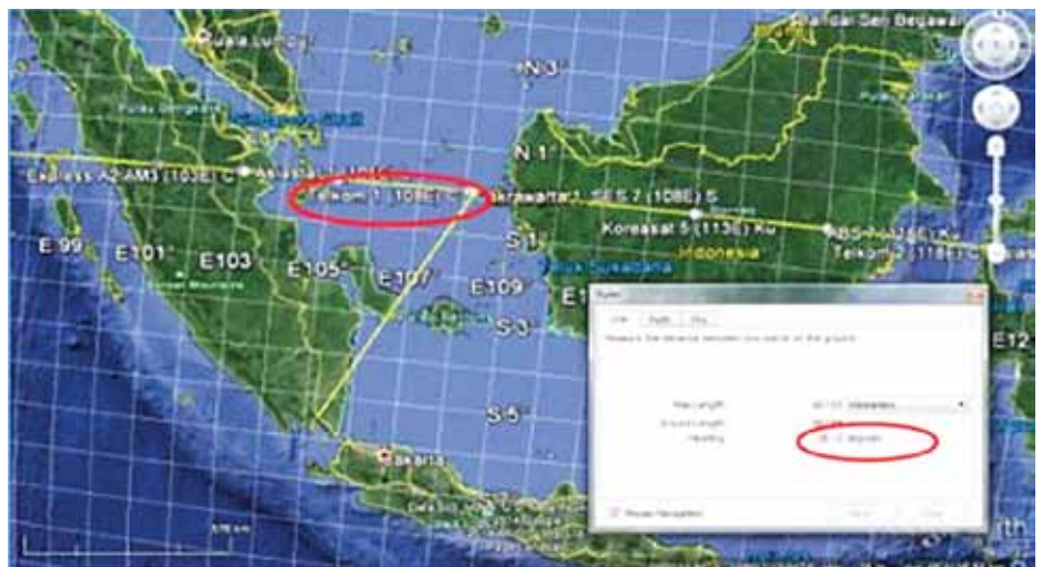
Gambar 5 : Menentukan Azimuth dan elevasi antenna BSS receiver menggunakan Google earth
